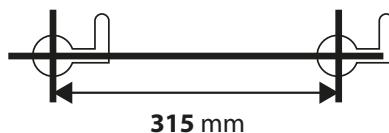
3. Pomocí vrtačky vyvrtejte montážní otvory. Na vrtání použijte 6 mm vrták. Hloubka otvorů musí být nejméně 26 mm hluboká. Nepoužívejte menší montážní velikost!
