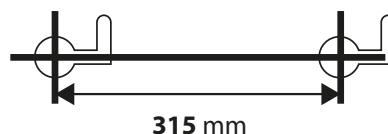
3. Practicați orificiile în locațiile marcate folosind mașina de găuri cu un burghiu adecvat. Folosiți un burghiu cu diametrul de 6 mm. Adâncimea găurilor trebuie să fie minim 26 mm. Nu folosiți elemente de fixare sub aceste dimensiuni!
