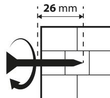
4. Vložte dodané hmoždinky do otvorů, dokud nebudou zarovnané s rovinou stěny.
