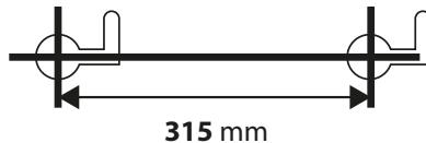
3. Pomocou vŕtačky vyvŕtajte montážne otvory. Na vŕtanie použite 6 mm vrták. Hĺbka otvorov musí byť najmenej 26 mm hlboká. Nepoužívajte menšiu montážnu veľkosť!
