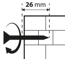
4. Vložte dodané hmoždinky do otvorov, kym nebudú zarovnané s rovinou steny.
