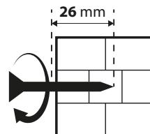
4. Setzen Sie die mitgelieferten Dübel in die Löcher ein, bis sie in einer Linie mit der Wand sind.
